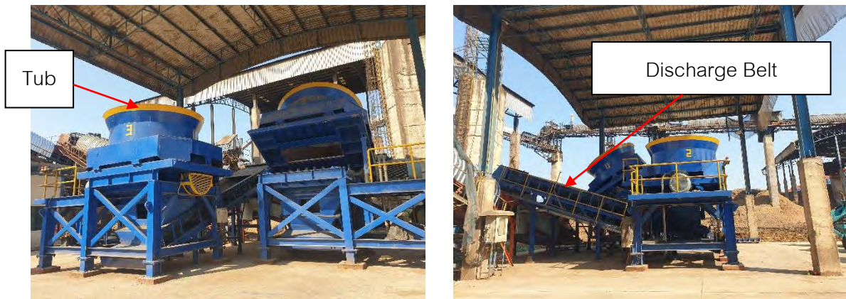
รูปที่ 2.3-3 ภาพถ่ายเครื่องย่อยใบอ้อย Tub Shredder และตำแหน่งติดตั้ง Discharge Belt
